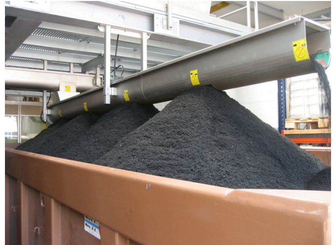
Abbildung 2: Austrag von entwässertem Klärschlamm zum Transport von der ARA zur Entsorgung
